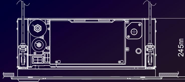
L'épaisseur de la nouvelle cassette 600x600 de 245 mm permet une installation dans les faux plafonds ayant peu de hauteur disponible.
